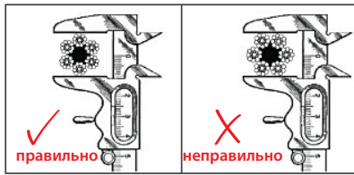
На рисунке показано, как правильно измерять стальной трос.
